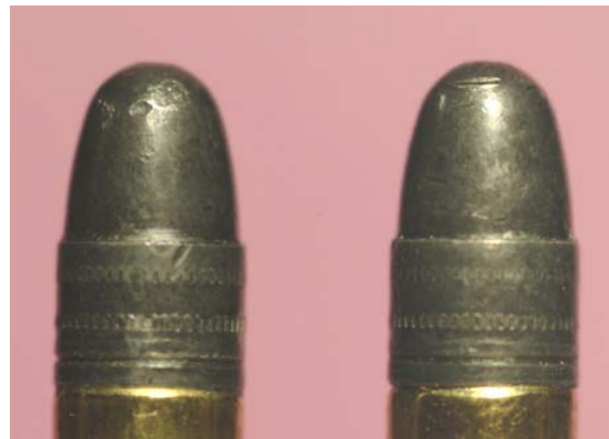
Figure 13: Défauts locaux sur une balle.
